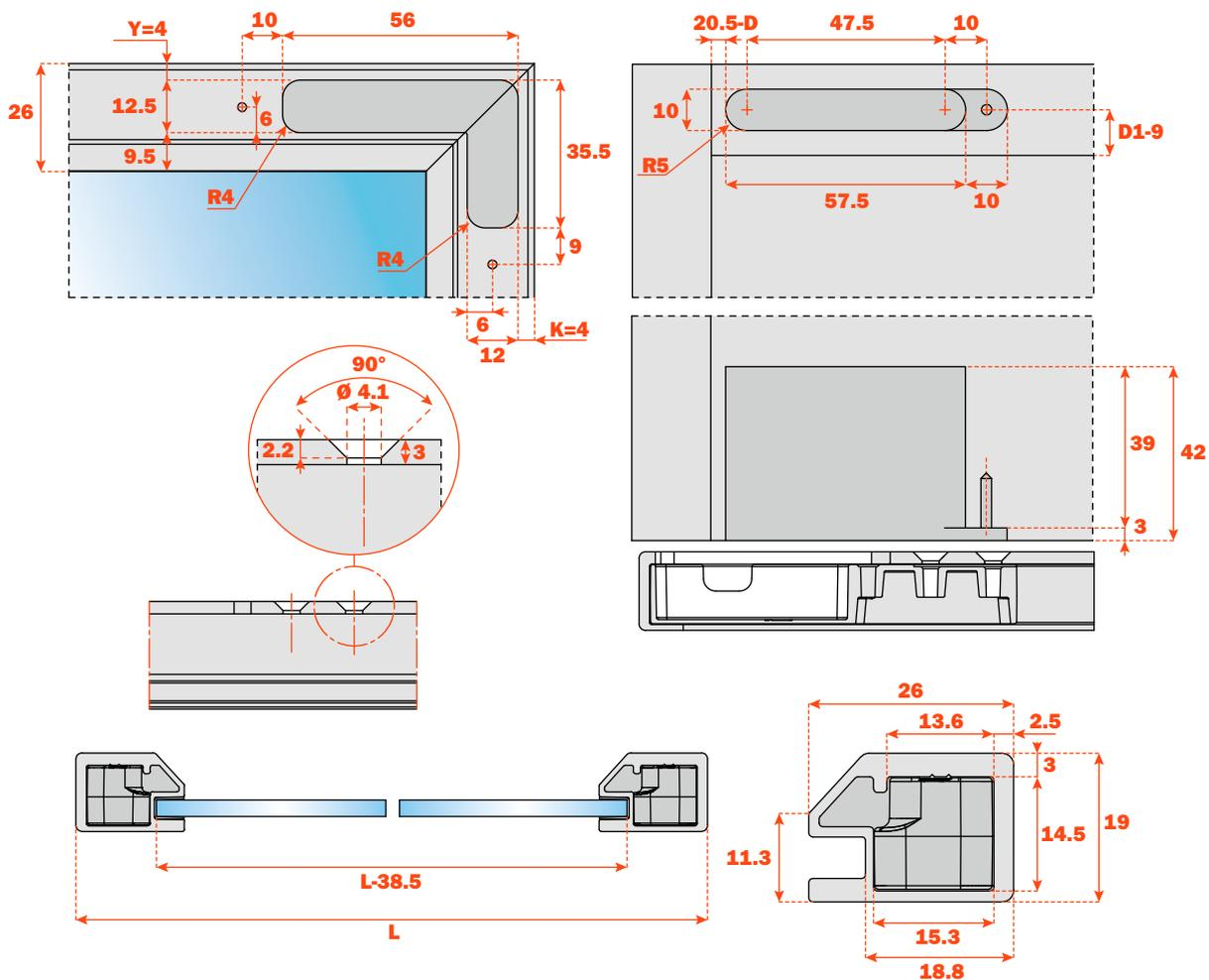
**Formeln für die Bestimmung des Abstandes für das Einsetzen der Aufnahmetaschen für den Scharnierarm.**
