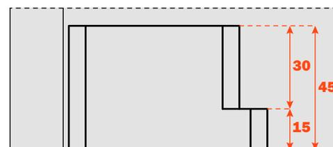
**Formeln für die Bestimmung des Abstandes für das Einsetzen der Aufnahmetaschen für den Scharnierarm.**
