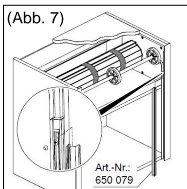
Kunststoff-Führungsprofil in das Korpusführungsprofil einsetzen und dabei hinter den Zapfen des Führungsrichters schieben (Abb. 7).
