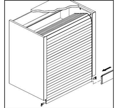
Transportsicherung der Rollladenmatte entfernen und die Matte in die Führung einziehen. Endprofil montieren (Achtung, wenn es nicht möglich ist, das Endprofil von unten zu montieren, vor dem Einfahren oben montieren).
