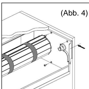
Rollladenbox bündig mit dem Korpus ausrichten und beidseitig mit den Seitenplatten des Korpus verschrauben (Abb. 4).
