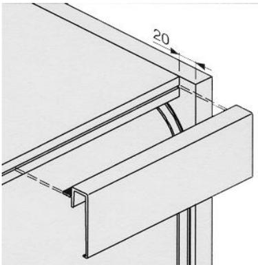
Bevor das Blendprofil montiert wird, kontrollieren ob die Vorspannung richtig ist. Wenn nicht, kann diese noch um weitere Drehungen vor oder zurück korrigiert werden.
