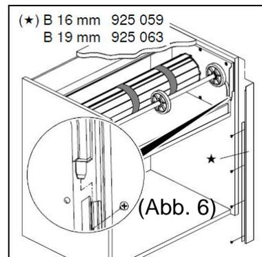
Achse zusammen mit den Umlenkrollen wieder einsetzen. Äussere Rollen vollständig auf die Lagerzapfen der Seitenteile schieben (Abb. 5).
