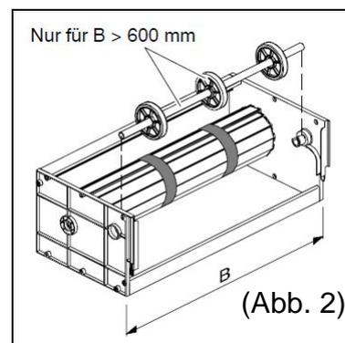
Seitliche Umlenkrollen auf der Achse nach innen schieben (Abb. 1). Achse aus den seitlichen Aufnahmen herausziehen (Abb. 2) und aus der Rollladenbox entnehmen.
